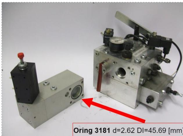
**Nota:** nell'articolo fornito come ricambio (codice 659017G02), contenente i vari O-ring di sostituzione, sono presenti anche 2 O-ring tipo 4187 (d=3.53 mm Di=47.22 mm) che non sono da utilizzare.
